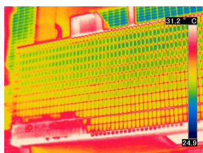
剥離壁面の温度が高い(赤)
