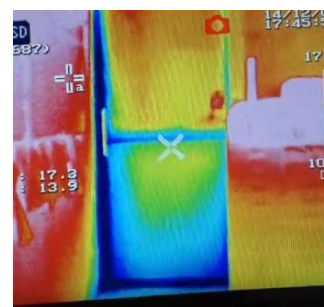
ドア枠付近からの冷氣漏れ(青)
